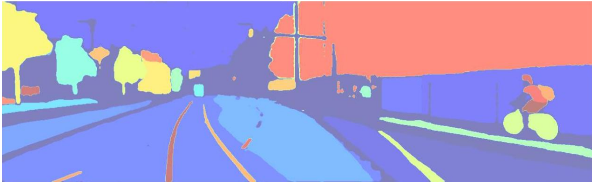
شکل ۳-۱۰: بخش‌بندی انجام‌شده توسط مدل سم
