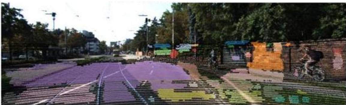
شکل ۳-۵: خروجی خوشه‌بندی ابر نقاط به همراه تصویر با استفاده از روش خوشه‌بندی دی‌بی‌اسکن و ویژگی‌های تصویر استخراج‌شده با مدل دیپ‌لب‌وی ۳
